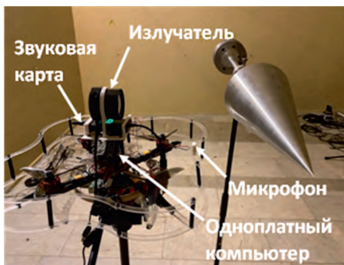
Рис. 2. Пример дифракционного эксперимента с прототипом летательного аппарата.
