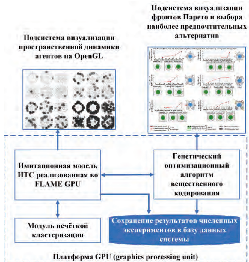
Рис. 2. Укрупненная архитектура программного комплекса, разработанного для ИТС.
